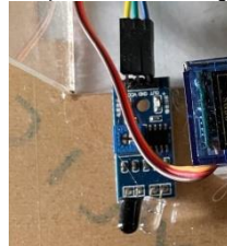
Gambar 4 Penempatan jalur keluar parkir infra red FC-51
