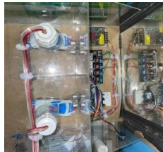
Gambar 9 AC Light Dimmer dan Lampu
