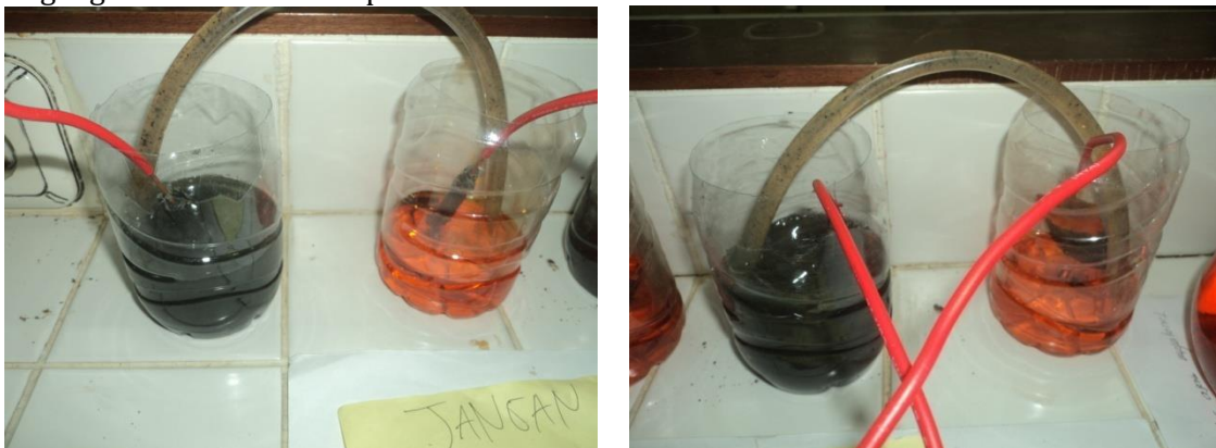
Gambar 4. Pengukuran voltase MFC: (a) elektroda karbon, C dan (b) elektroda paduan, Cu/C
