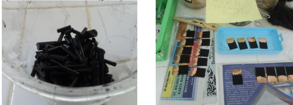
Gambar 3. Elektroda MFC: (a) elektroda karbon, C dan (b) elektroda paduan, Cu/C
